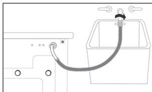
2. Подсоедините другой конец шланга для подачи воды к крану холодной воды, и затяните соединение рукой. В случае необходимости, вы можете изменить положение конца шланга для подачи воды, подключенного к стиральной машине, для чего ослабьте фитинг, поверните шланг и вновь затяните фитинг.
