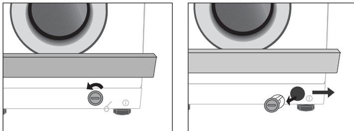
4. Смойте грязь и удалите другой мусор из фильтра. Убедитесь в том, что расположенные сзади фильтра лопасти сливного насоса не заблокированы грязью. Верните на место крышку фильтра.
