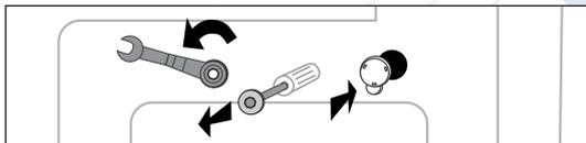
1. Ослабьте все транспортировочные болты при помощи поставляемого с машиной гаечного ключа перед их удалением.
